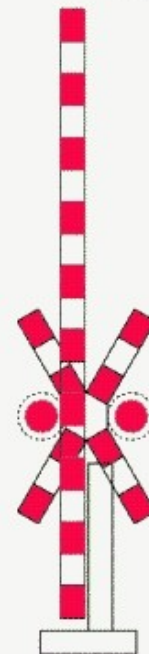
Trecere la nivel cu o cale ferată simplă cu semibarieră, prevăzută cu semnale luminoase de avertizare a apropierii trenului
