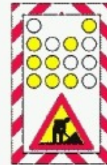
Semnalizarea unui utilaj care se deplasează lucrând
