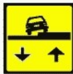
Denivelare față de banda alăturată
