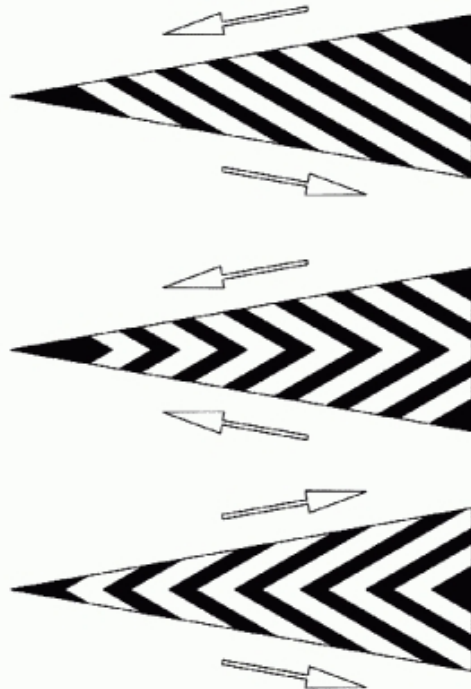
Spații interzise circulației
